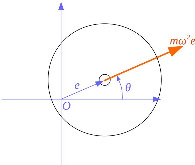
Claramente a projeção desta força na direção vertical é  $m\omega^2 e \sin \theta$ .
