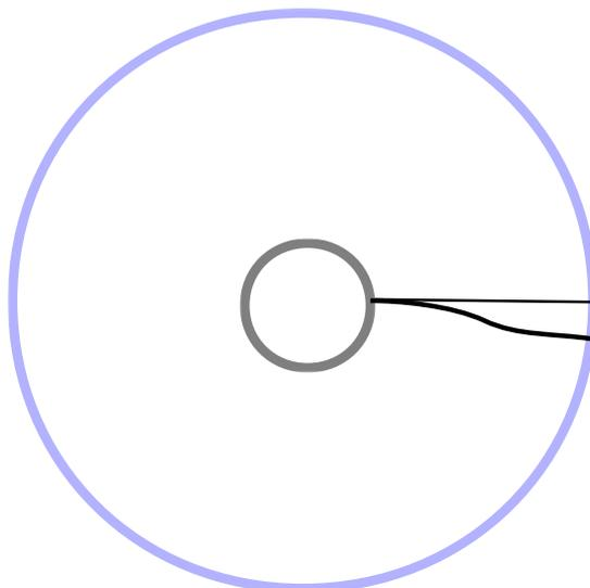
Como estamos considerando apenas pequenos deslocamentos, a deflexão na extremidade da viga conectada ao aro em pode ser calculada como  $y = (r_a - r_c)\theta$ , onde  $r_a$  e  $r_c$  são os raios interno do aro e externo do cubo, respectivamente. É dado no formulário que para uma viga biengastada a relação entre a deflexão e a carga aplicada é dada por
