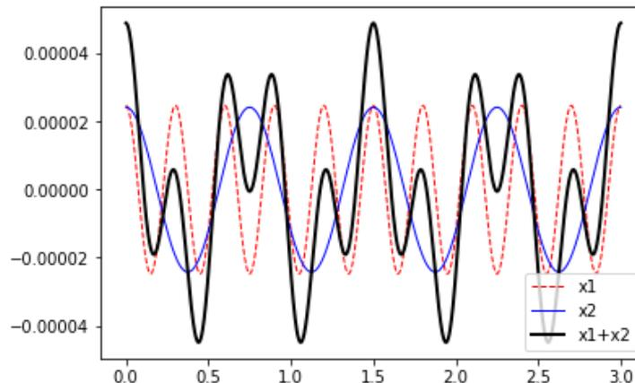
É claro que determinar o valor máximo desta função não é fácil, no entanto, é uma consideração de engenharia muito razoável admitir que existem pontos nos quais as duas funções estarão em fase e a amplitude será a soma das duas amplitudes.
